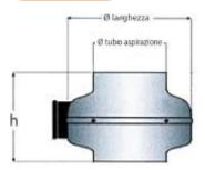
Aspiratore elettrico per cappe. Cassonetto esterno arrotondato da installare sopra la cappa. Portata max 325 m³/h
